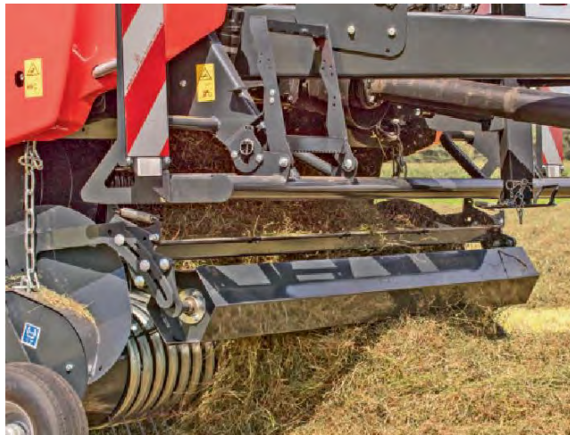
KUHN покладається на керований підбирач із п'ятьма рядами граблин. Важливо з точки зору продуктивності: новий притисковий ролик для культури з пружинними граблями.
