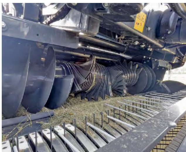
Гвинтові конвеєри і ротор інтегровані на одному валу, а не на окремих валах. Це інтегральний ротор, розроблений у Geldrop у 1996 році.
