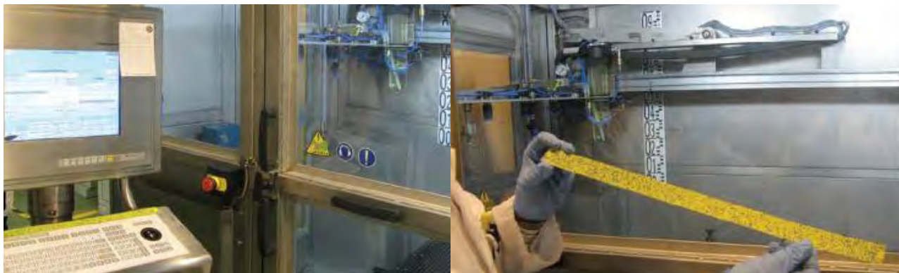
Фото 1, 2: Лабораторне обладнання для моделювання різних умов обприскування — швидкості, тиску, типу розпилювачів (в лабораторії погодні умови, на жаль, врахувати неможливо).
