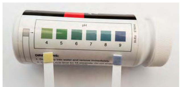
Рис. 2. Додавання гліфосату знизить рН бакової суміші на 2–3 одиниці залежно від початкового рН, складу та швидкості дії гліфосату. РН після додавання 1% гліфосату (450 г/л) — менше 4 (жовта тест-смужка). Водопровідна вода — справа.
