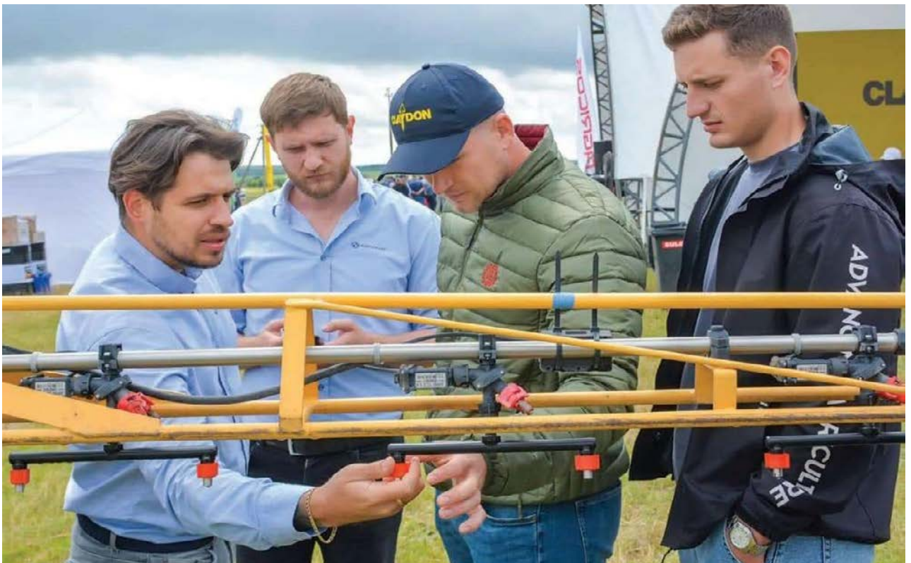
Фото 2. Микола Гринь разом з партнерами в Молдові, компанією Агроцентр ЄвроХім, провели презентацію і зробили тест-драйв розпилювачів L-Cultan — інноваційних повноструменевих розпилювачів для внесення КАСу в ґрунт.
