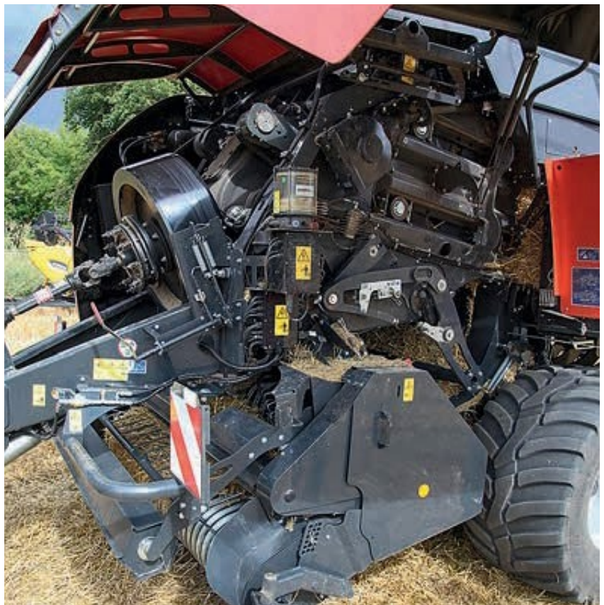
Підбирач тепер на 13 см ширший і може похвалитися приводним роликотом подачі діаметром 250 мм перед ротором. Коток «адаптується» до форми валка. KUHN збільшив продуктивність свого SB 1290 ID, який здатний упакувати понад 500 кг в тюк довжиною 2,30 м зі швидкістю 44 т/год.
