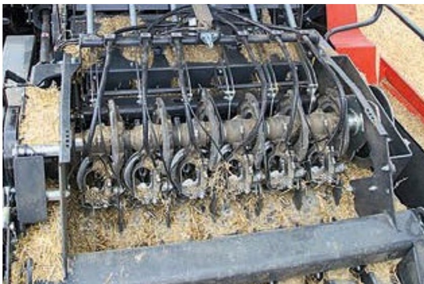
Шість подвійних вузлів'язальників створюють короткі обрізки, але потужні вентилятори зберігають територію чистою.
