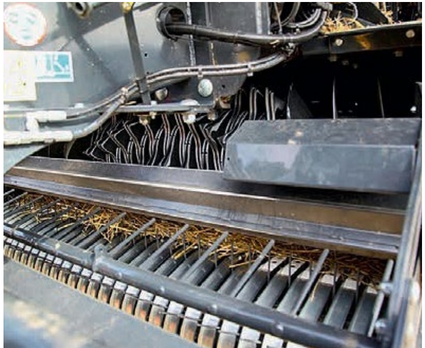
Підбирач тепер на 13 см ширший і може похвалитися приводним роликотом подачі діаметром 250 мм перед ротором. Коток «адаптується» до форми валка. KUHN збільшив продуктивність свого SB 1290 ID, який здатний упакувати понад 500 кг в тюк довжиною 2,30 м зі швидкістю 44 т/год.
