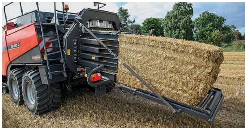
Бокові частини пресувальної камери тепер отримують тиск 3 гідроциліндрами на кожен бок. Жолоб має точну вбудовану систему зважування. У наступному сезоні буде доступний двокомпонентний виштовхувач тюків.
