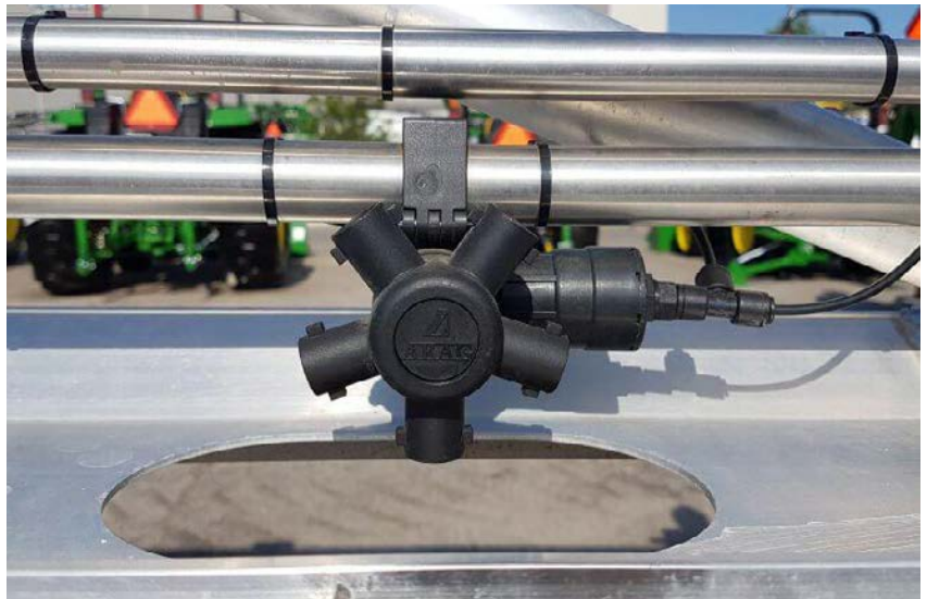
Пневматический клапан-відсікач для кожної форсунки дозволяє зменшити розмір секції за розумні гроші.
