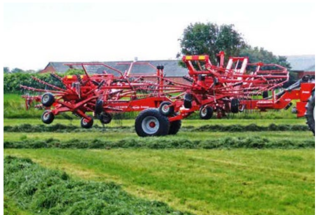
Все більші і більші машини виправдовують розширення MGM в Монсвіллері. Роторні граблі GA 4 з робочою шириною захвату 15 м.
