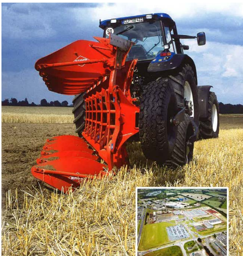
Реверсний шестикорпусний плуг. На вставці вид на завод KUHN-Huard на початку 2000-х років. У 1999 року виробництво об'єднали у єдиний новий завод площею 32 000 кв. метрів.
