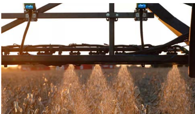
Малюнок 7: Оптичне точкове обприскування (WEEDit Quadro) (Джерело: WEED-it.com)
