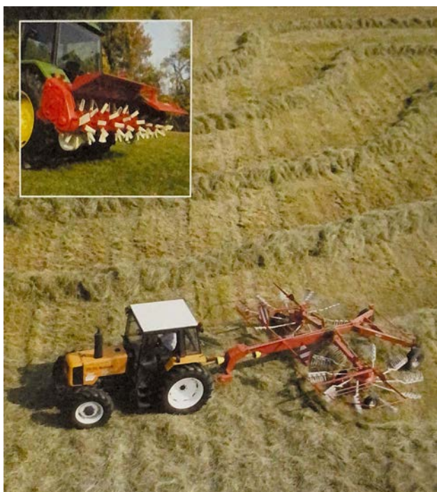
Двороторні граблі з центральною подачею та шириною згрібання 7,30 м. Вставка: Грунтофреза, нова машина для обробки землі.
