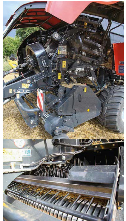
Підбирач став ширше на 13 см і тепер має перед ротором 25-сантиметровий подавальний ролик з активним приводом.
